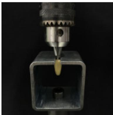
**Figura 2** - Conjunto adaptado na máquina universal de ensaios EMIC DL 2000
