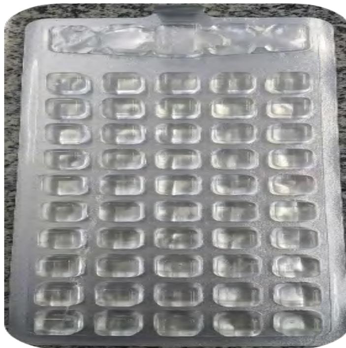
**Figura 4** - Quantitray apresentando teste negativo para bactérias coliformes totais após 24 horas
