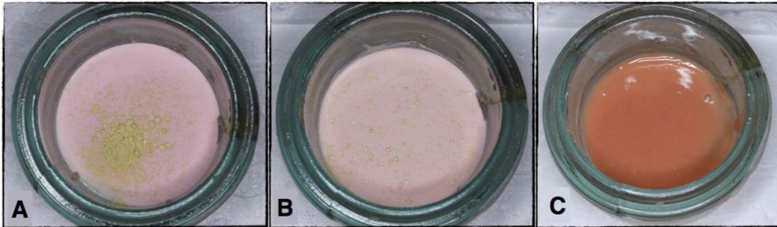
Figura 2 - (A) Concentração inibitória mínima do fármaco (nistatina) adicionada ao pó do reembasador Trusoft; (B) mistura dos pós (fármaco e reembasador); (C) material manipulado após a adição do líquido
