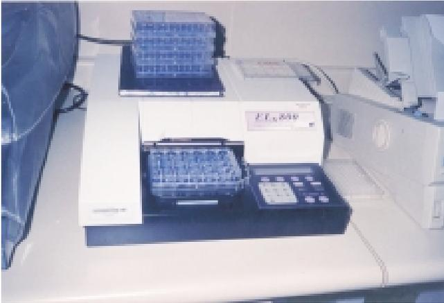
Figura 2 – Leitor de microplacas (ELX 800)
