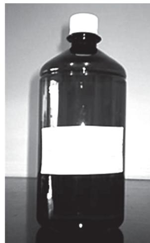
Figura 1 - Solução de hipoclorito estocada em frasco de 1.000 mL do tipo garrafa Pet de cor âmbar, com tampa rosqueável
