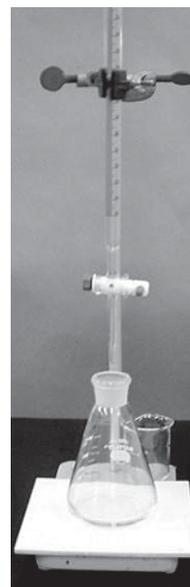
Figura 5 - Titulação do tiossulfato de sódio (0,1N) sob agitação, até a solução ficar incolor
