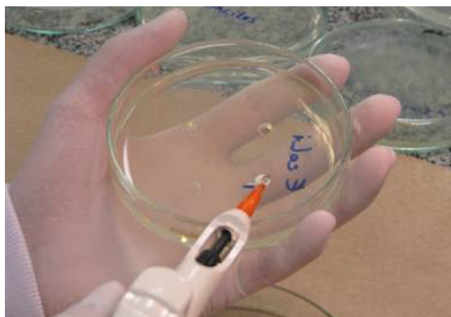
Figura 2 - Preenchimento dos poços com cimento endodôntico com auxílio de uma seringa Centrix
