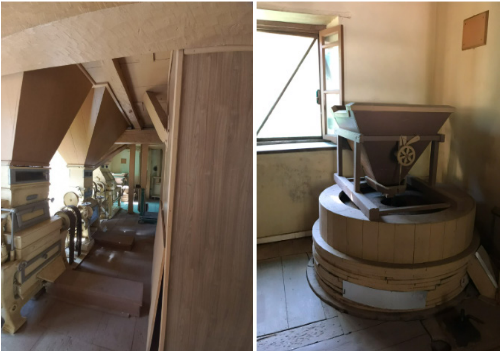
Figura 2 – Máquinas de produção de farinha de trigo e mó de pedra envolta em madeira para moagem de milho
