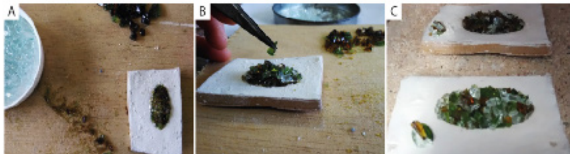
Figura 6 – Segundo e terceiro testes: (A) formas com uma camada espessa de caulim e pedacinhos bem pequenos de vidro na base; (B) colocação de pedacinhos de vidro ultrapassando a altura da forma no segundo teste; (C) formas levadas ao forno no terceiro teste
