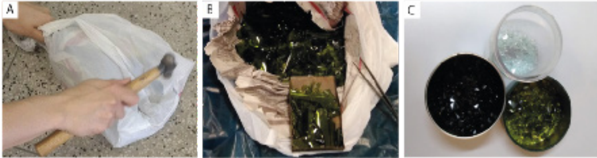
Figura 4 – Processo de quebra do vidro: (A) amostras sendo quebradas com martelo; (B) rejeitos de vidro selecionados; (C) separação dos rejeitos de vidro em diferentes cores, prontos para utilização
