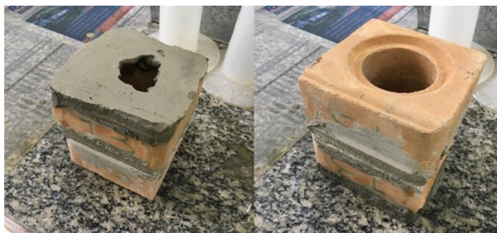
Figura 4 – Tijolos cortados ao meio, superpostos com a pasta de cimento e capeados
