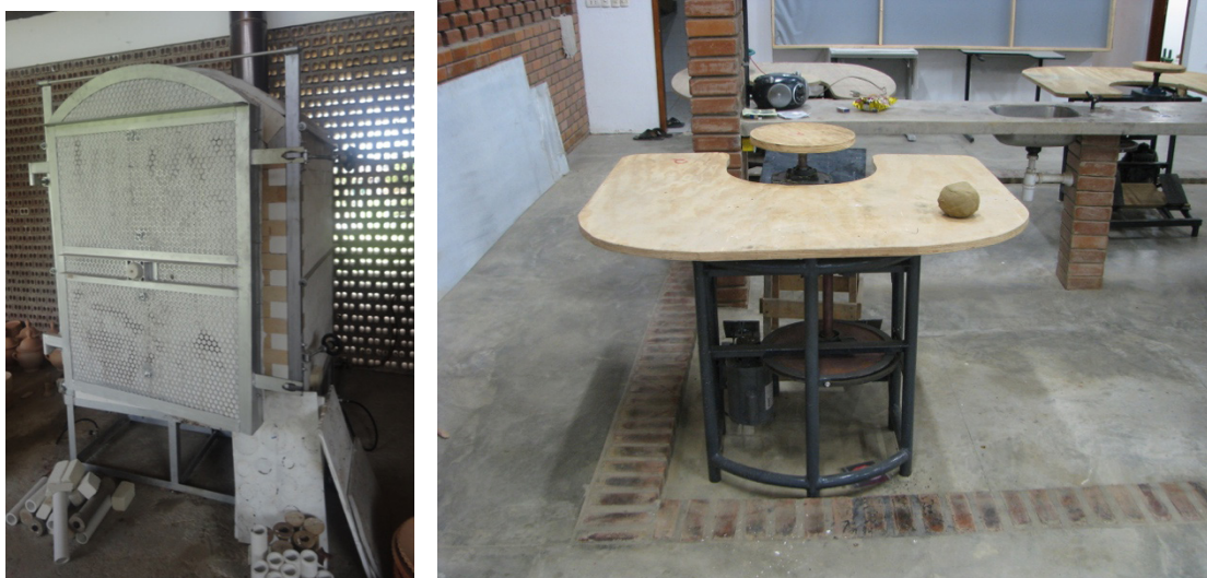
Figura 5 – Forno a gás instalado, testes da primeira queima e tornos instalados
