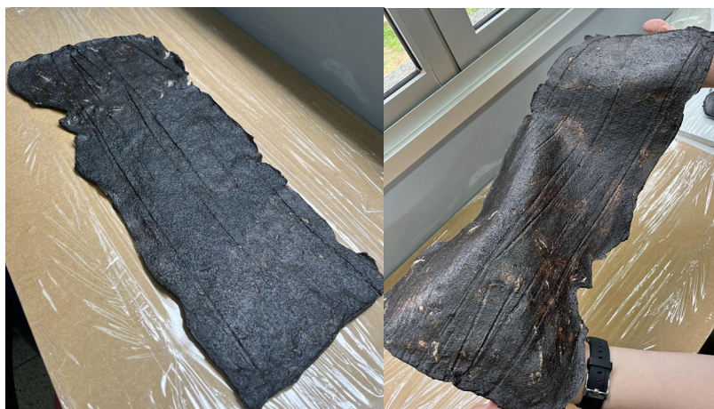
Figura 4 – Resultado da produção D com material de 80 x 20 cm: seco, sem presença de mofo, com textura de couro
