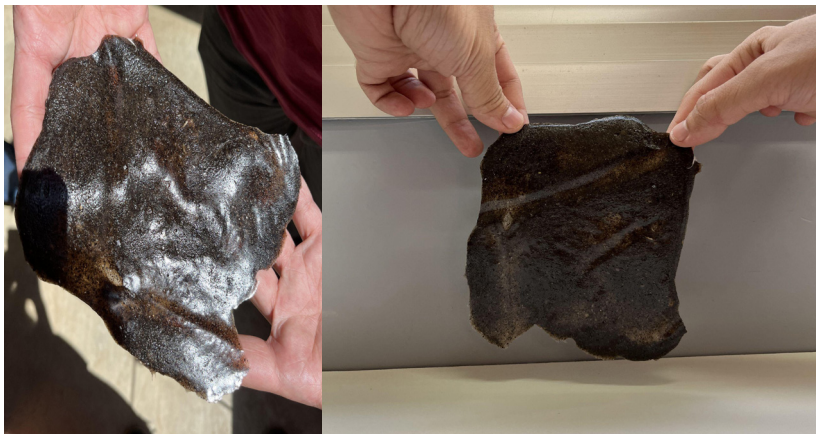
Figura 3 – Resultado da produção C: com material seco, sem presença de mofo e com aparência preliminar de corino
