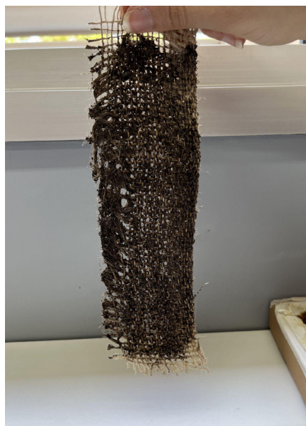
Figura 2 – Resultado da produção B: material aplicado em juta, sem aderência total e sem presença de mofo
