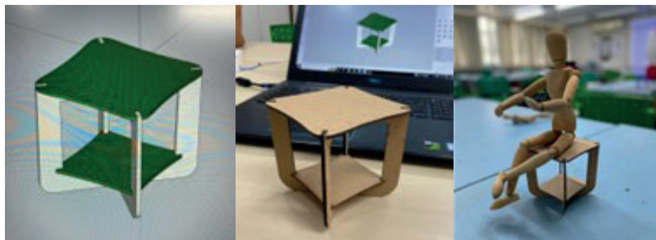
Figura 11 – 2.º modelo no SketchUp 3D e corte a laser em papel Paraná na cortadora a laser (validação)
