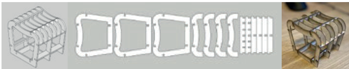
Figura 10 – 1.º modelo no SketchUp 3D, estratégia de corte/ nesting e plano seriado e corte a laser em papel Paraná
