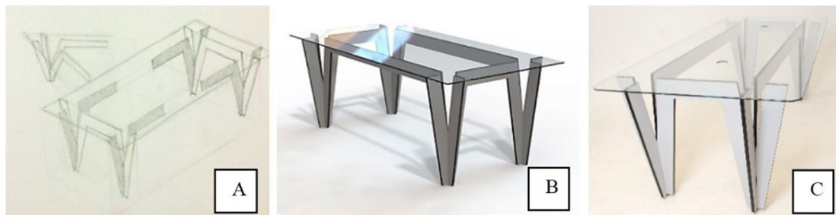
Figura 1 – Processo de desenvolvimento (A e B) e protótipo (C) de mesa de reuniões
