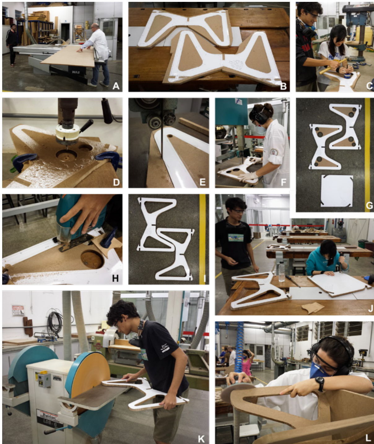
Figura 7 – Processo de produção das peças do protótipo do banco Catraca. Painel de MDF sendo cortado na Altendorf® (A); pernas do banco com gabarito (B); corte da chapa com serra copo (C e D); peças sendo cortadas pela serra de fita (E e F); componentes dos produtos após alguns processos de transformação (G); corte dos vazados internos com a serra tico-tico (H); pernas do banco antes do lixamento (I); início do lixamento com equipamentos e limas (J-L)
