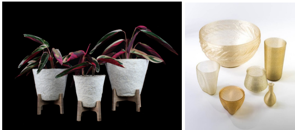
Figura 1 – Vasos à base de compósito de micélios e peças impressas em três dimensões com biopolímeros de algas
