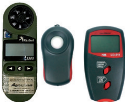
Figura 3 – Medidor de multiparâmetros e luxímetro, respectivamente. Fonte: primária.
